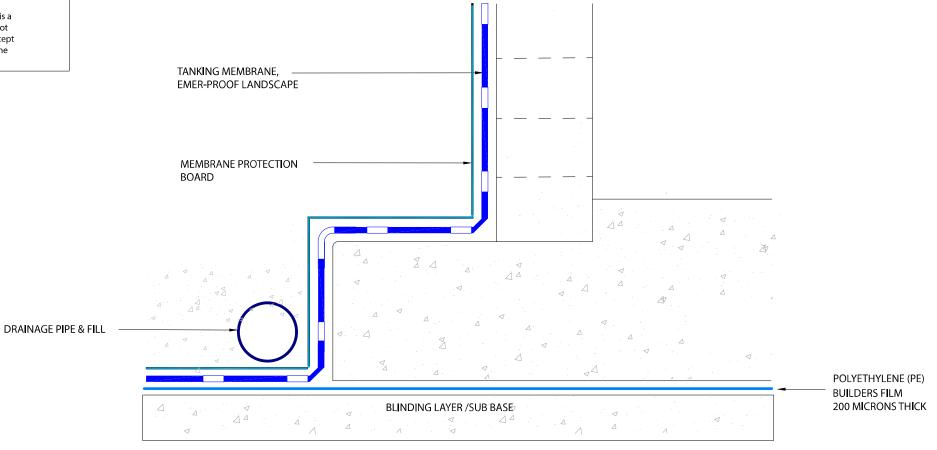
BELOW GROUND TANKING - TYPICAL FOUNDATION DETAIL
