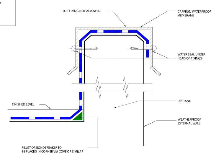
EDGE PROTECTION OF MEMBRANE OVER A PARAPET
